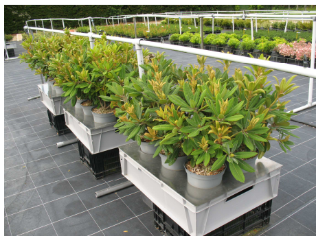
Dispositif de mesure de lessivage en continu pour une culture en conteneur, L. Mary
