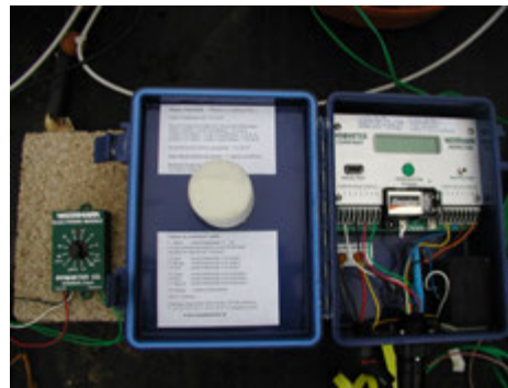
Boîtier d'enregistrement des valeurs tensiométriques
