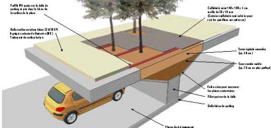
Détail de la sortie vers les cuvettes du jardin
